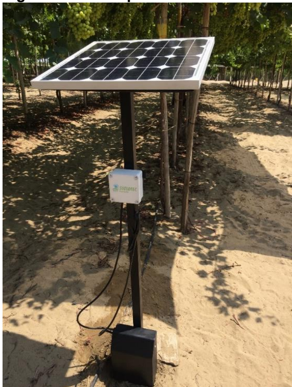
Figura 36: Prototipo estación edáfica Suelotec en campo agrícola
