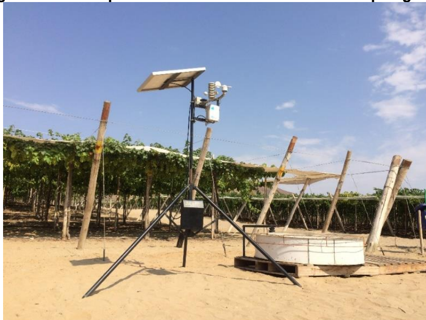
Figura 35: Prototipo estación climático Uklima en campo agrícola
