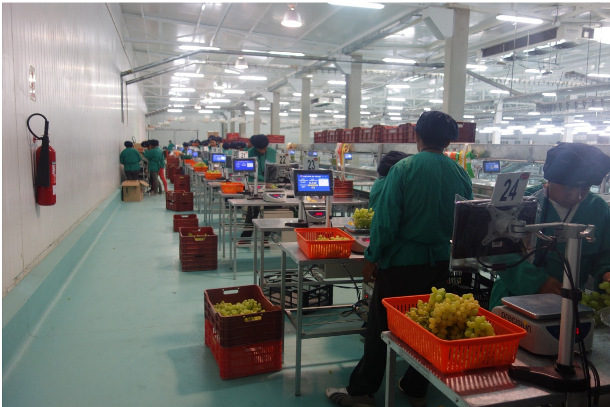
Figura 32. Sistema de pesaje instalado
