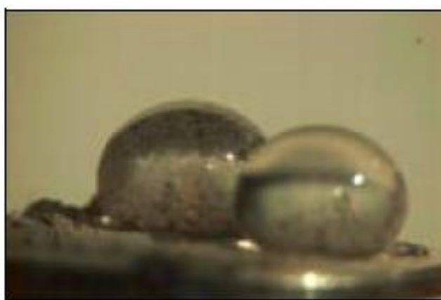
Figura 1: Vista de una gota de agua durante el efecto de penetración de la superficie del material estabilizado por el polímero PAM
