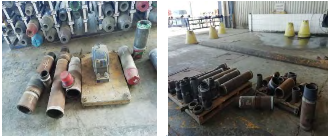
Figura 67. Evidencia de falta de clasificación de tubulares en racks Fuente: Fotografía propia
