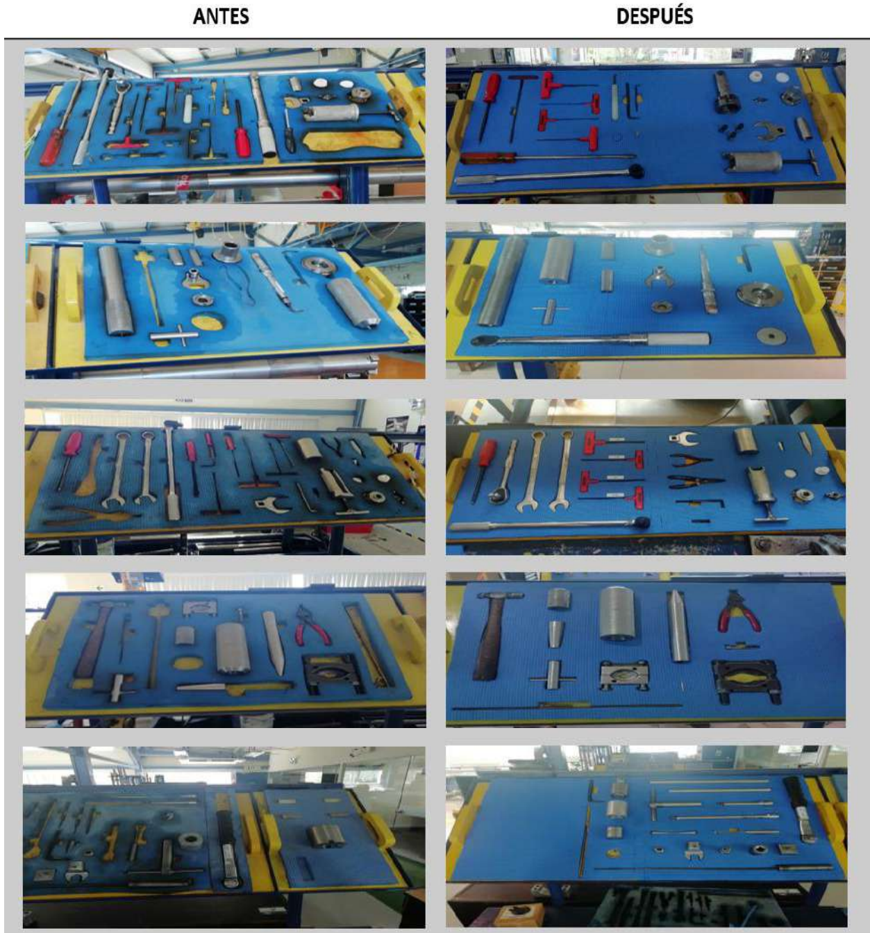
Figura 81. Antes y después de implementar Poka Yoke con shadow boards para las mesas de trabajo Fuente: Elaboración propia
