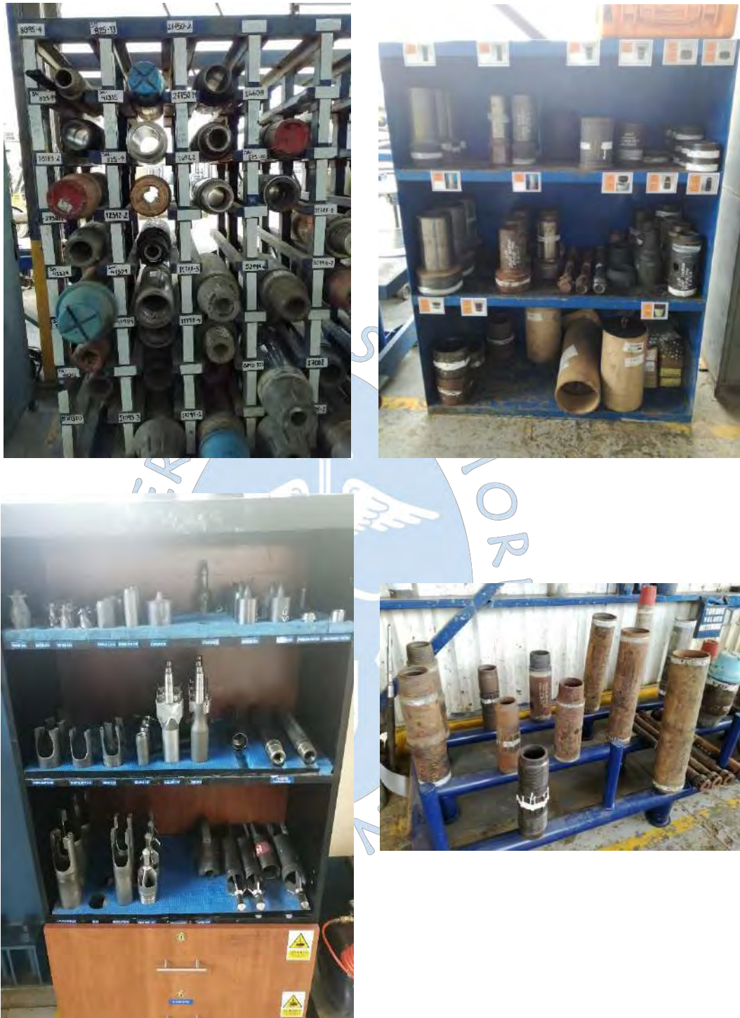
Figura 70. Organización, orden y etiquetado de tubulares en rack Fuente: Fotografías propias
