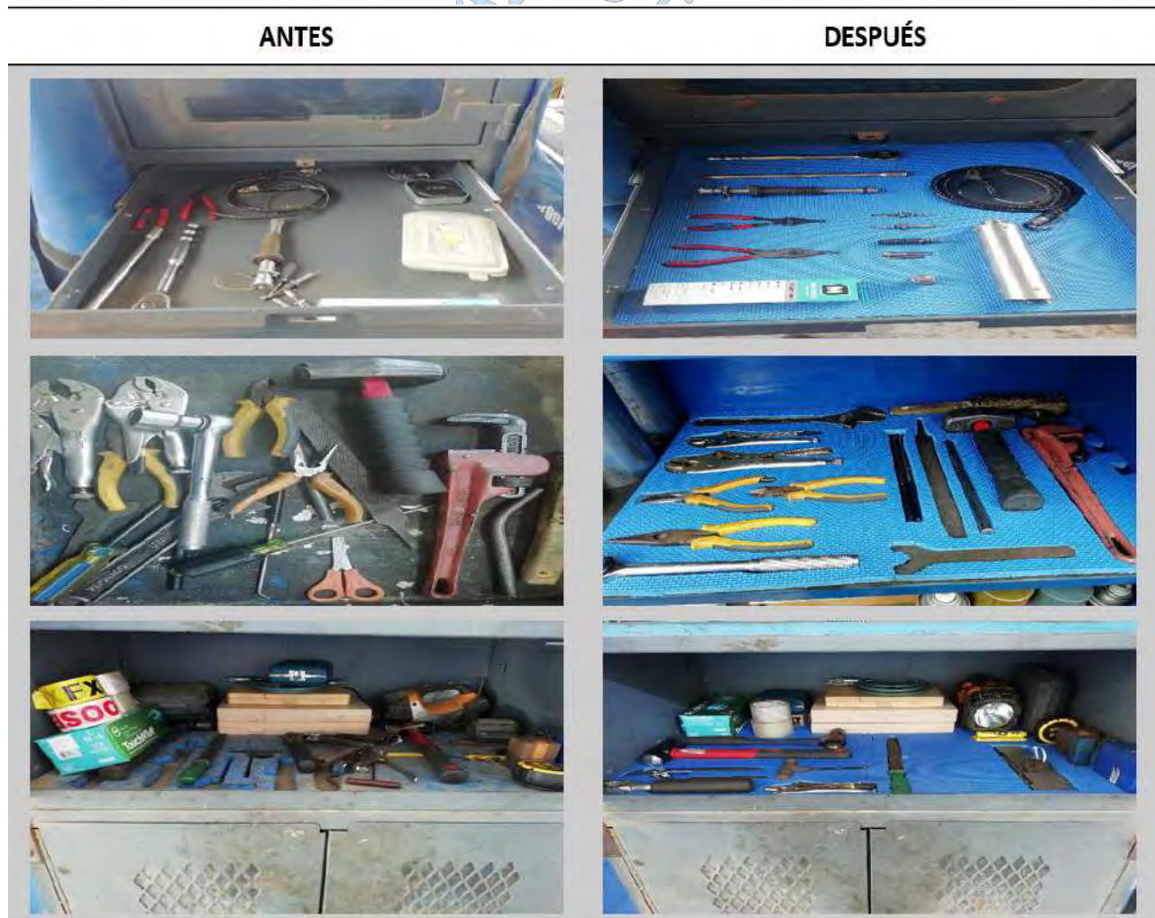
Figura 80. Antes y después de implementar Poka Yoke con shadowboards para los estantes y carritos de configuración
