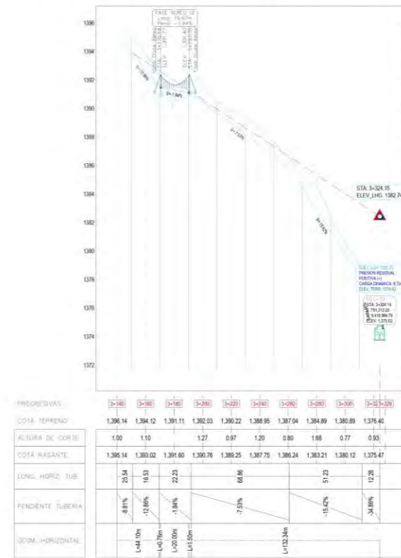
PERFIL LONGITUDINAL: 3+140.00-3+328.00 Esc. H = 1/1500 Esc. V = 1/150 → Exag. 10m
