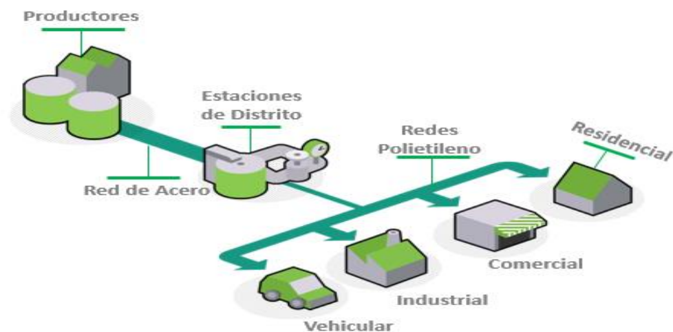
Figura 7 Esquema de distribución de gas natural mediante red de ductos de acero
