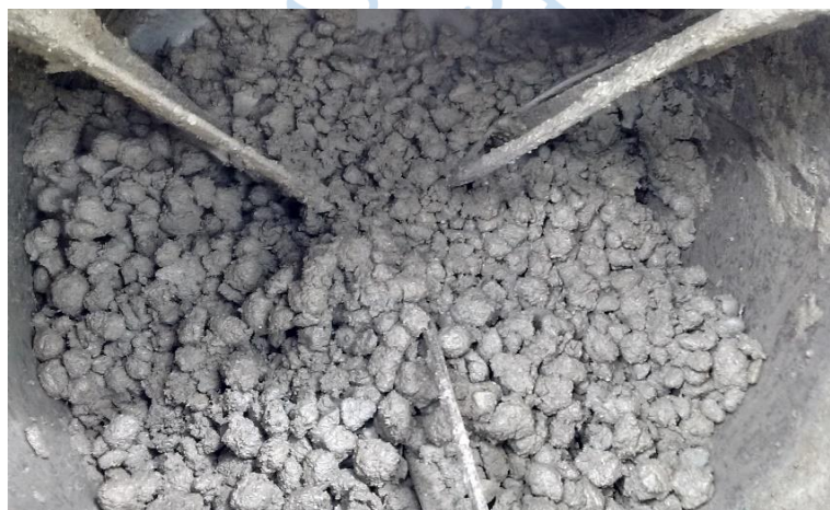
Figura 13: Segregación del agregado grueso e insuficiente pasta dentro de la mezcla de una tanda con microsílice antes de llegar al orden de mezclado óptimo de los componentes.
