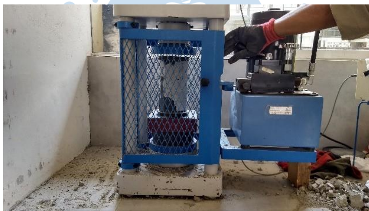
Figura 6. Ensayo a la compresión en prensa hidráulica.
