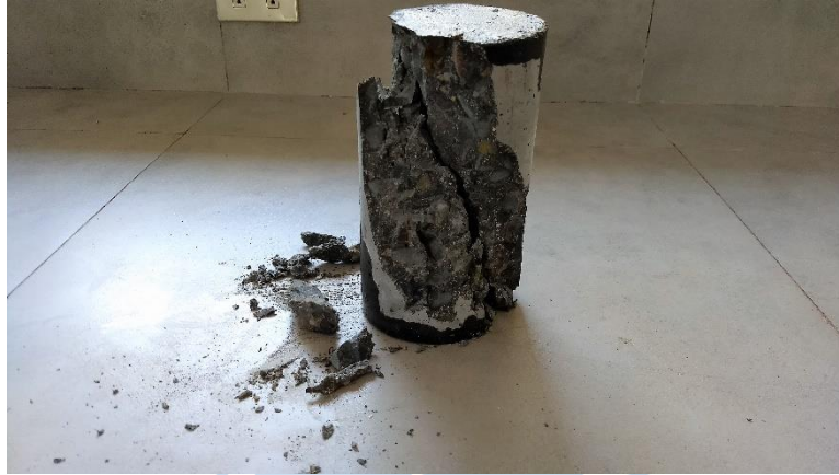
Figura 21. Fractura diagonal sin grietas en la base.
