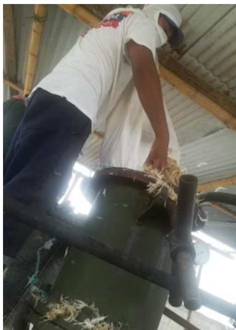
Figura 34: Ingreso de plumas al digestor Fuente: Elaboración Propia
