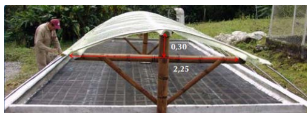
Ilustración 24 Secador solar directo tipo parabólico.
