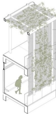
ISOMETRICO DE MALLA METÁLICA
