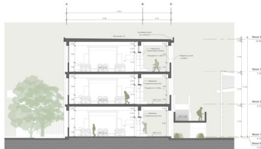
A.16 CORTE B - BLOQUE A Escala 1 : 75
