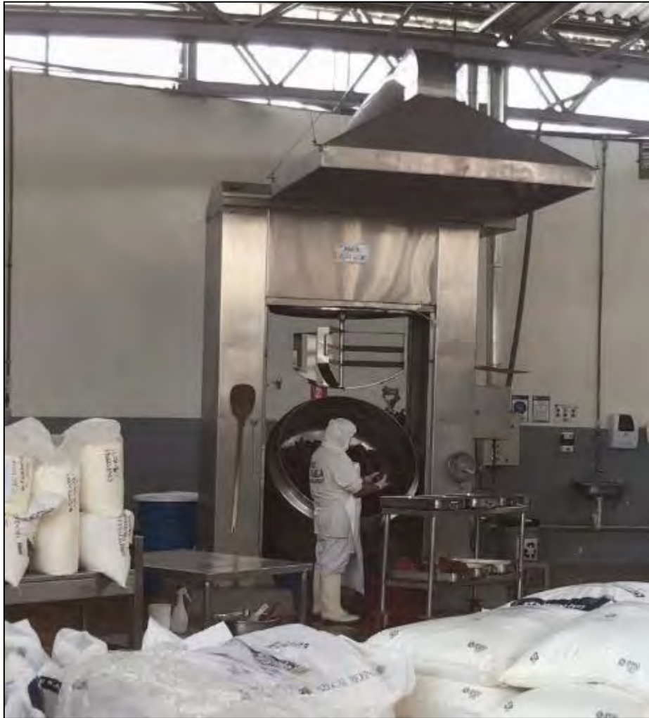
Figura 21. Agitador industrial de camote junto al operario manejando la máquina
