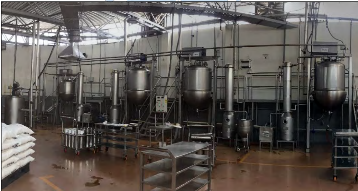
Figura 20. Sistemas de 4 pailas entrelazadas entre sí mismas llevando a cabo la elaboración del manjar
