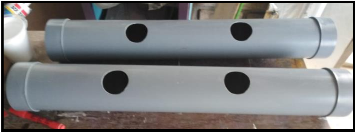
Ilustración 31. Tubos usados para la parte hidropónica Fuente: Propia
