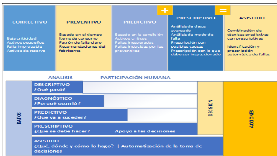
Figura 51 Modelo de Mantenimiento con industria 4.0
