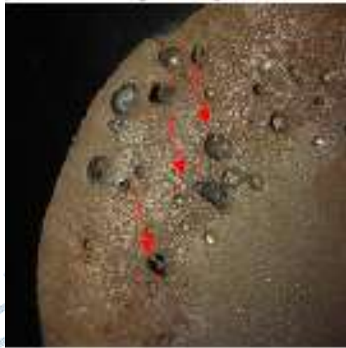
Figura 17. Corte transversal de la muestra M19, Taller 1, con cavidades esféricas subsuperficiales (sopladuras).
