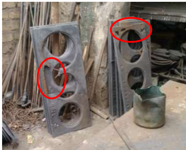
Figura 5. Plancha de aro base para cocina con defecto de material faltante (defecto más común Taller 13)
