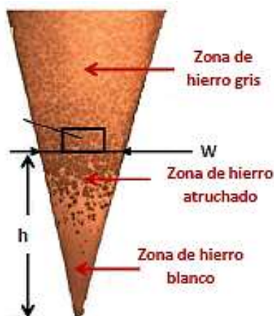
Figura 13. Esquema de tendencia al blanqueo, probeta tipo cuña. Profundidad de blanqueo (h) y blanqueo total (W)
