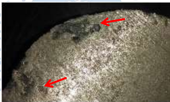
Figura 16. Sección transversal de la muestra M30, Taller 5. Se muestran cavidades de forma irregular dentro de las paredes de la pieza.
