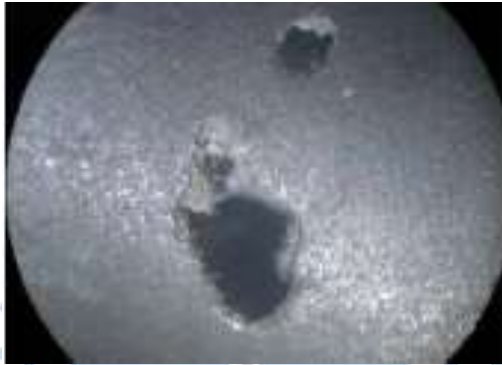
Figura 19. Sección transversal de la muestra M23, Taller 4. Se muestran cavidades de forma irregular con inclusiones de escoria.
