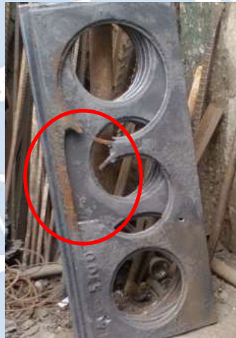
Figura 22. Aro base con parte de fundición incompleta en la muestra M7 del taller 13.
