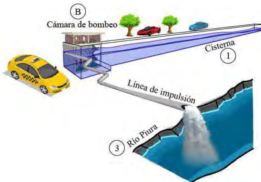
Figura 7 Sistema de drenaje pluvial Fuente: Elaboración propia
