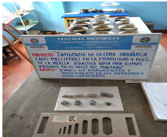
Figura 51: Ensayo de índice de alargamiento Fuente: Laboratorio Centauro Ingenieros
