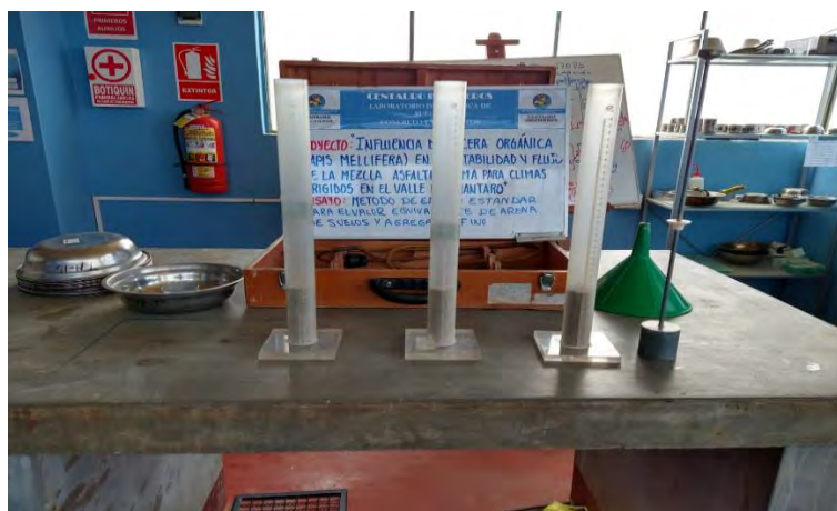
Figura 54: Ensayo equivalente de arena Fuente: Laboratorio Centauro Ingenieros
