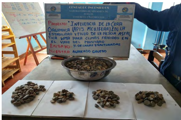
Figura 84: Ensayo partículas chatas y alargadas Fuente: Laboratorio Centauro Ingenieros
