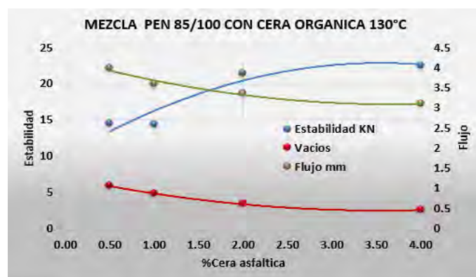
Figura 126: Relación flujo estabilidad vacíos; mezcla Asfáltica con cera orgánica 130°
