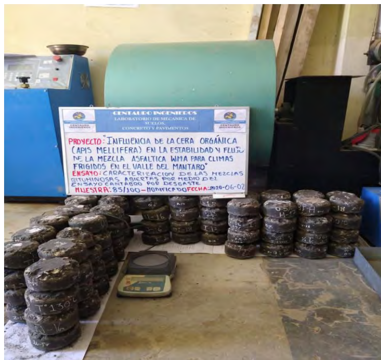
Figura 105: Briquetas ensayadas cántabro Fuente: Laboratorio Centauro Ingenieros
