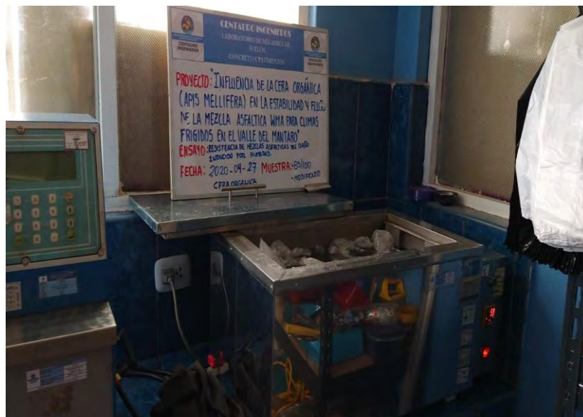
Figura 113: Primer ciclo de deshielo Fuente: Laboratorio Centauro Ingenieros
