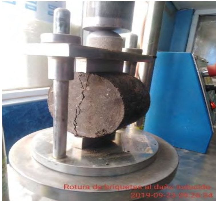
Figura 71: Rotura de briqueta Marshall Test lottman Fuente: Laboratorio Centauro Ingenieros
