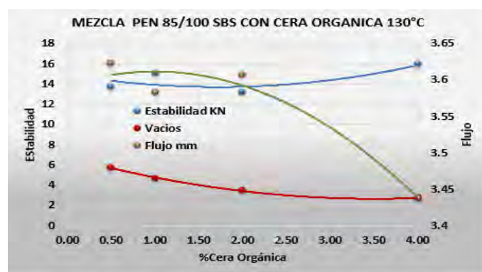
Figura 137: Relación flujo, estabilidad, vacíos mezcla Asfáltica PEN 85/100 SBS con cera orgánica a 130°C
