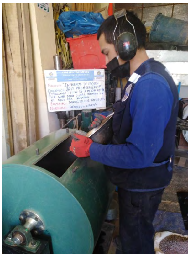
Figura 75: Ensayo de abrasión de los ángeles
