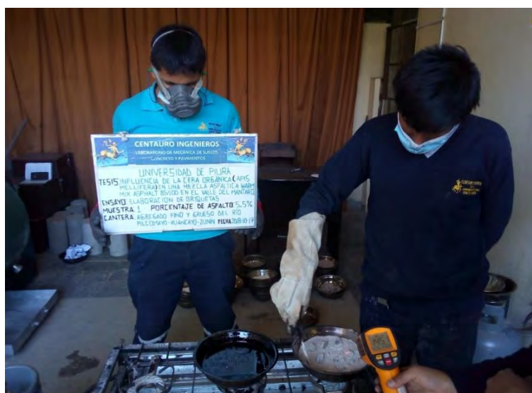
Figura 88: Fabricación mezcla Asfáltica Fuente: Laboratorio Centauro Ingenieros
