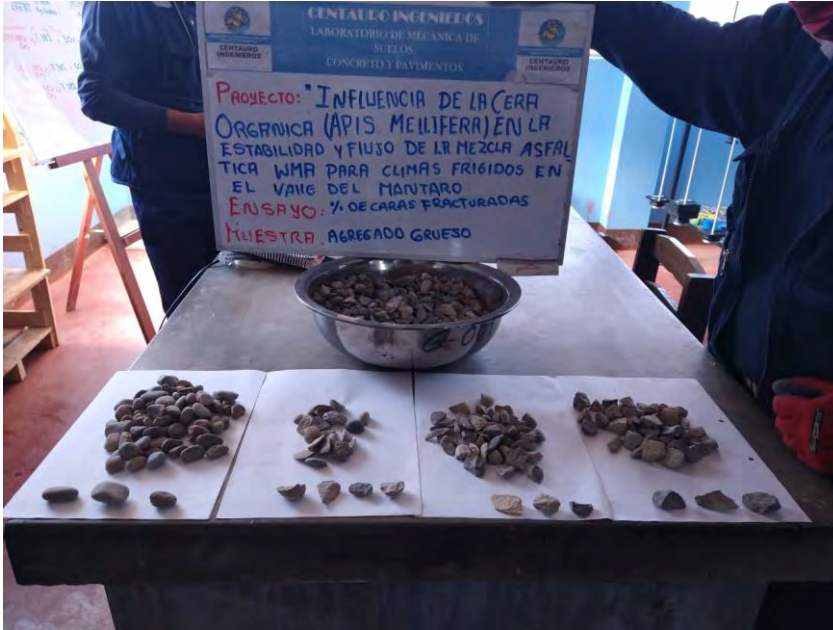
Figura 76: Ensayo de partículas chatas y alargadas Fuente: Laboratorio Centauro Ingenieros
