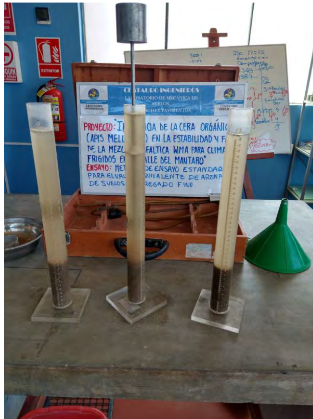
Figura 78: Ensayo equivalente de arena Fuente: Laboratorio Centauro Ingenieros
