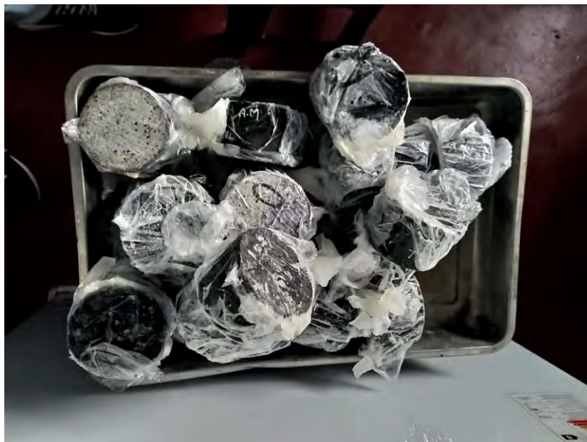
Figura 115: Briquetas congeladas Fuente: Laboratorio Centauro Ingenieros
