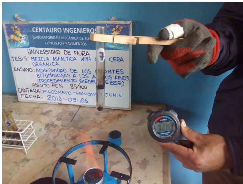
Figura 82: Ensayo Riedel Weber control de desprendimiento Fuente: Laboratorio Centauro Ingenieros
