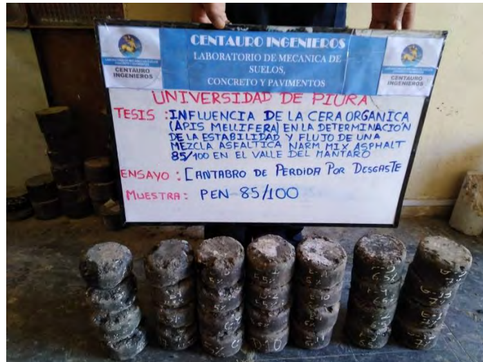
Figura 66: Resultado de briquetas ensayo Cántabro Fuente: Laboratorio Centauro Ingenieros
