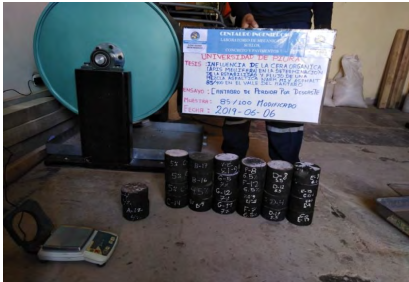
Figura 101: Ensayo Cántabro mezclas Asfáltica Fuente: Laboratorio Centauro Ingenieros
