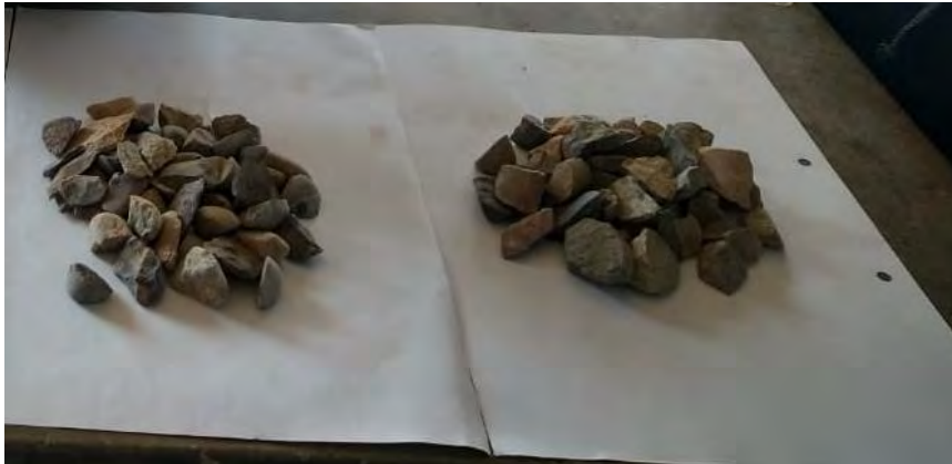
Figura 53: Ensayo porcentaje de partículas fracturadas Fuente: Laboratorio Centauro Ingenieros
