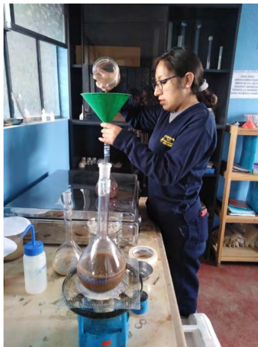
Figura 46: Ensayo Gravedad especifica finos Fuente: Laboratorio Centauro Ingenieros
