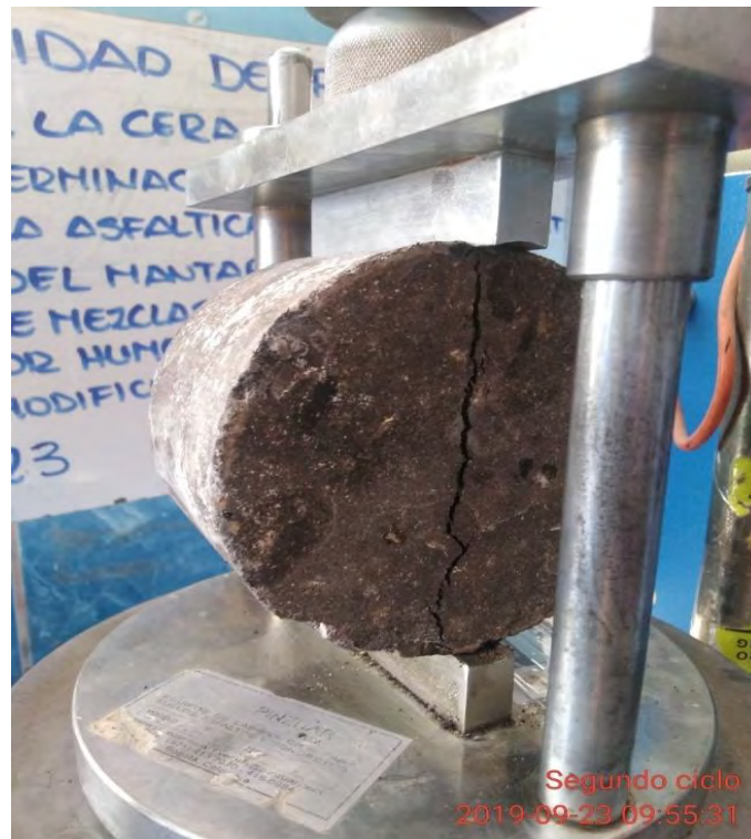
Figura 110: Test de Lottman Fuente: Laboratorio Centauro Ingenieros
