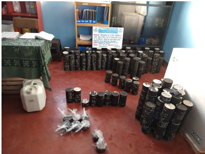
Figura 92: Briquetas de mezcla Asfáltica Fuente: Laboratorio Centauro Ingenieros
