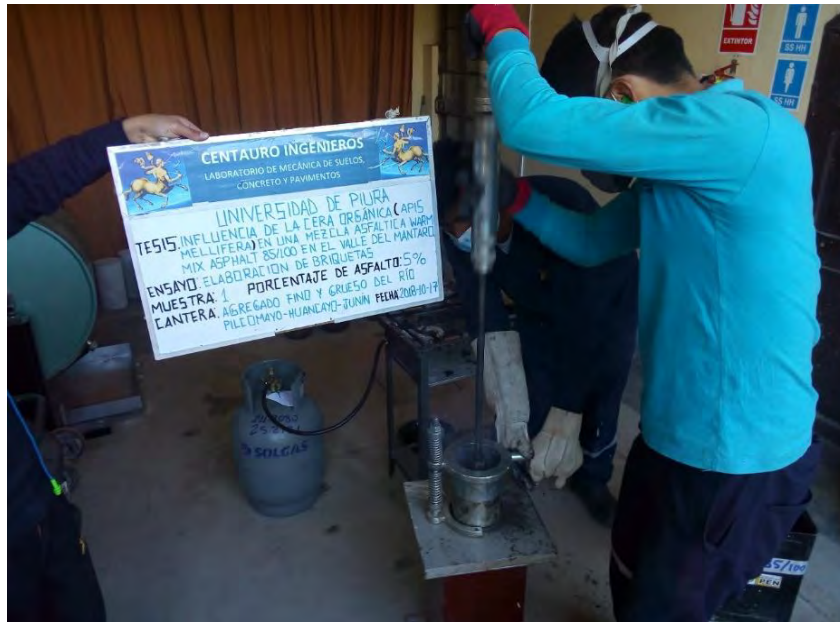
Figura 91: Compactación de mezcla Asfáltica Fuente: Laboratorio Centauro Ingenieros
