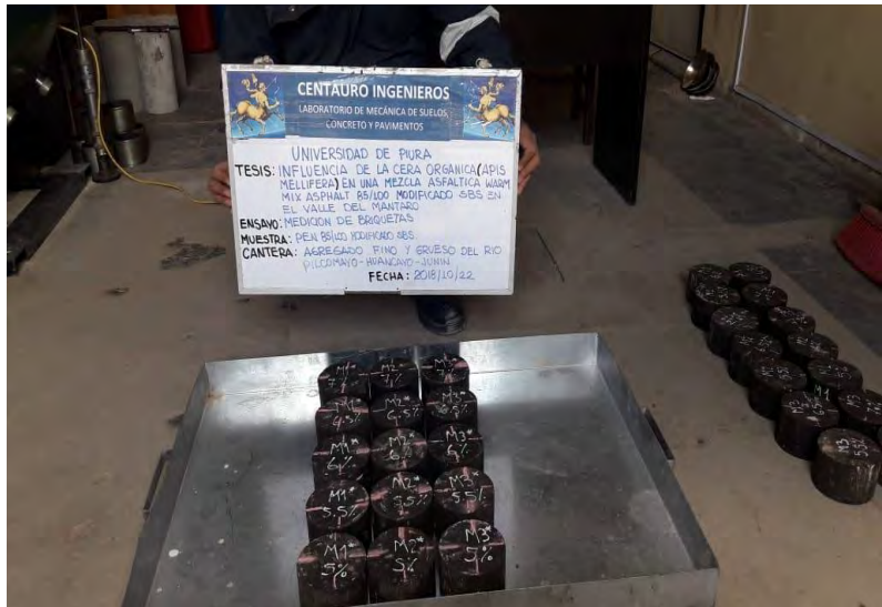
Figura 93: Briquetas para ensayo Cántabro Fuente: Laboratorio Centauro Ingenieros
