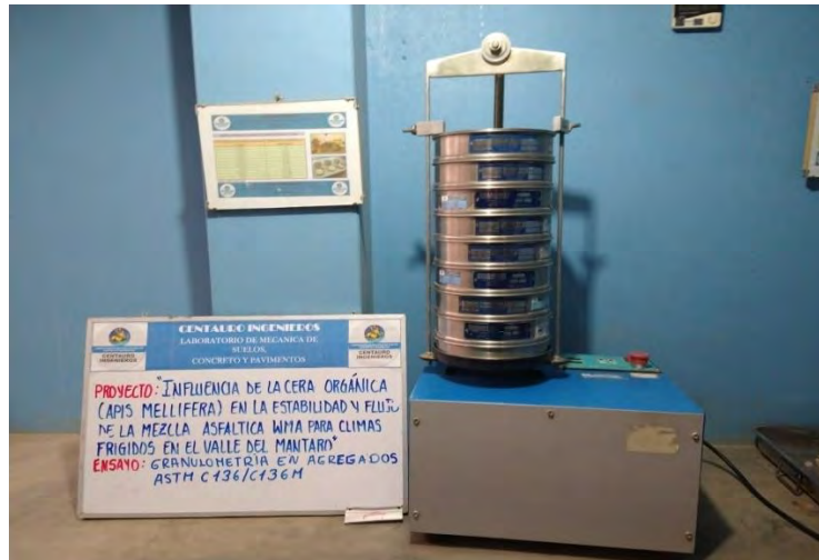
Figura 45: Granulometría Fuente: Laboratorio Centauro Ingenieros
