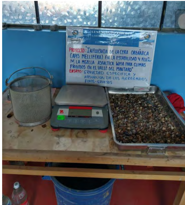
Figura 79: Ensayo de gravedad específica en agregado grueso Fuente: Laboratorio Centauro Ingenieros
