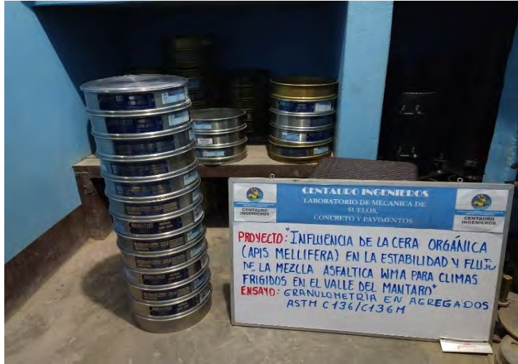
Figura 44: Columna de tamices Fuente: Laboratorio Centauro
