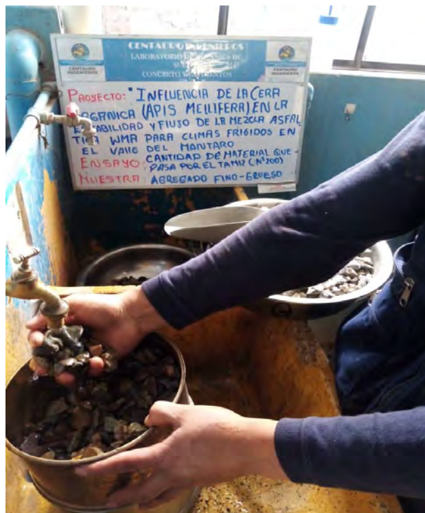
Figura 85: Ensayo pasante malla 200 Fuente: Laboratorio Centauro Ingeniero
