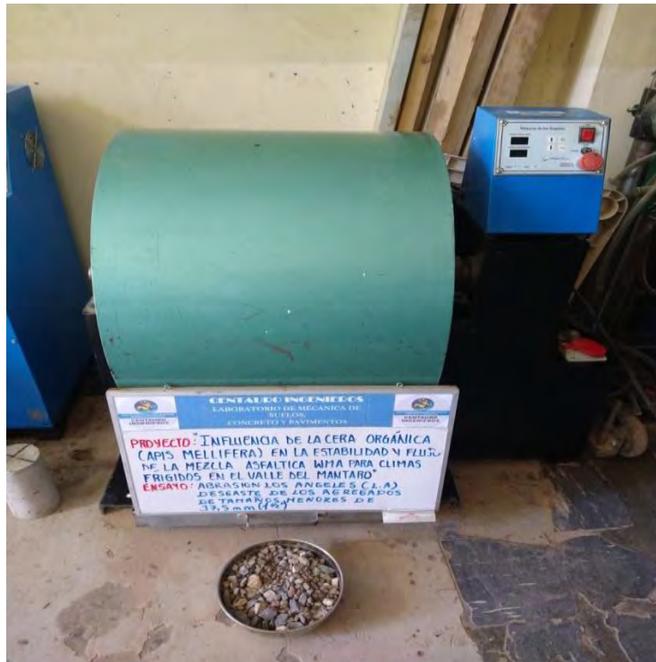
Figura 49: Equipo máquina de los ángeles Fuente: Laboratorio Centauro Ingenieros
