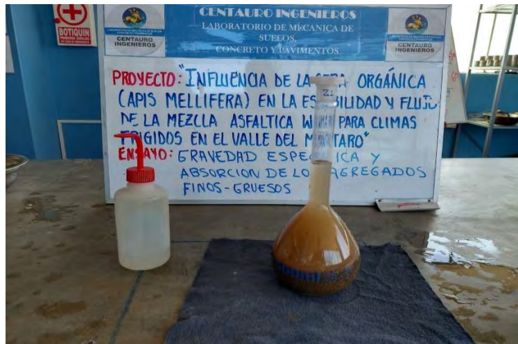
Figura 47: Ensayo absorción de agregados Fuente: Laboratorio Centauro Ingenieros
