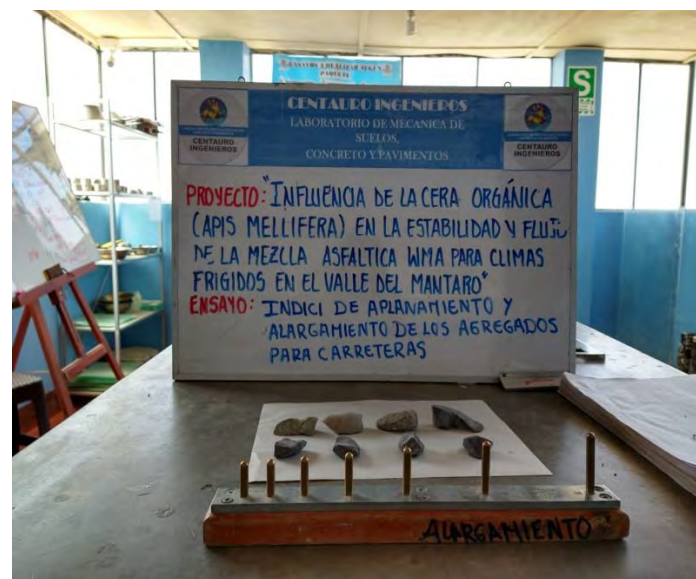
Figura 52: Ensayo índice de aplanamiento Fuente: Laboratorio Centauro Ingenieros
