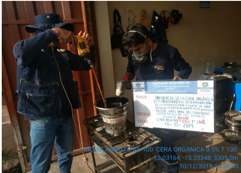
Figura 100: Doble modificación asfalto SBS Fuente: Laboratorio Centauro Ingenieros
