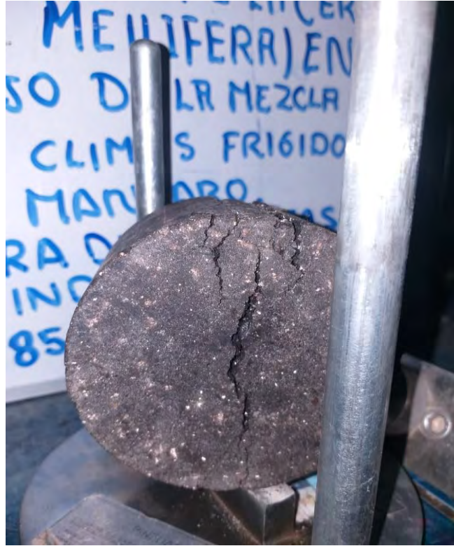
Figura 118: Briqueta ensayada test lottman Fuente: Laboratorio Centauro Ingenieros
