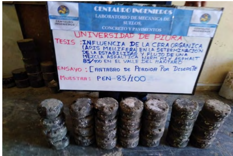
Figura 102: Briquetas luego del ensayo Cántabro Fuente: Laboratorio Centauro Ingenieros
