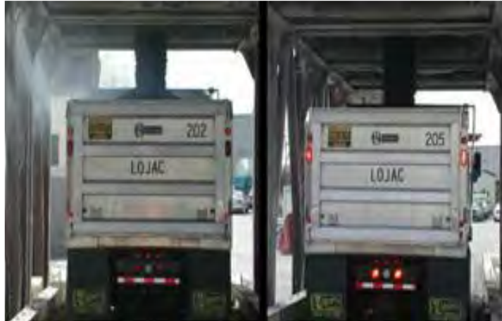
Figura 36: Mezcla caliente T 160°C, Mezcla tibia T 121°C Fuente: Corrigan, 2012
