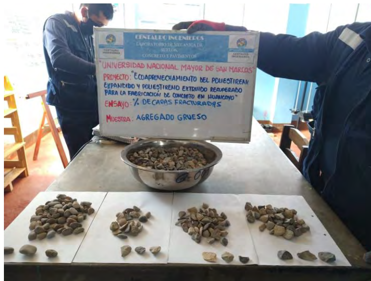
Figura 77: Ensayo Índice de aplanamiento y alargamiento Fuente: Laboratorio Centauro Ingenieros
