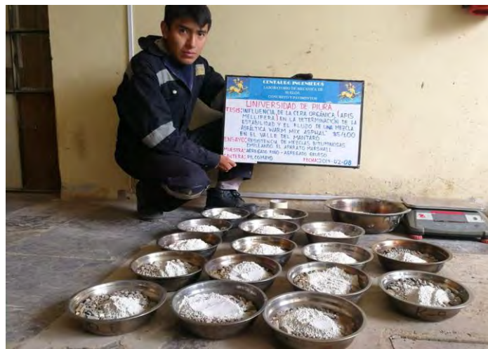
Figura 56: Muestra para preparar mezcla asfáltica Fuente: Laboratorio Centauro Ingenieros
