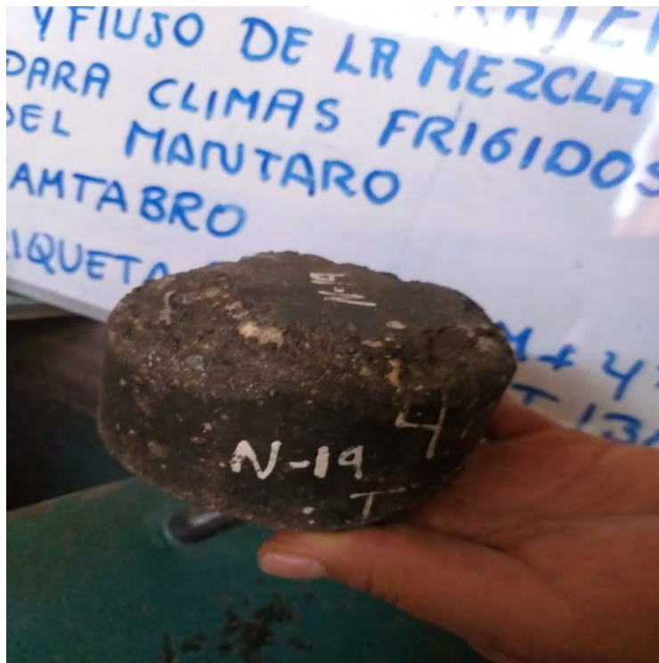
Figura 106: Ensayo cántabro briqueta 4% asfalto 130°C Fuente: Laboratorio Centauro Ingenieros
