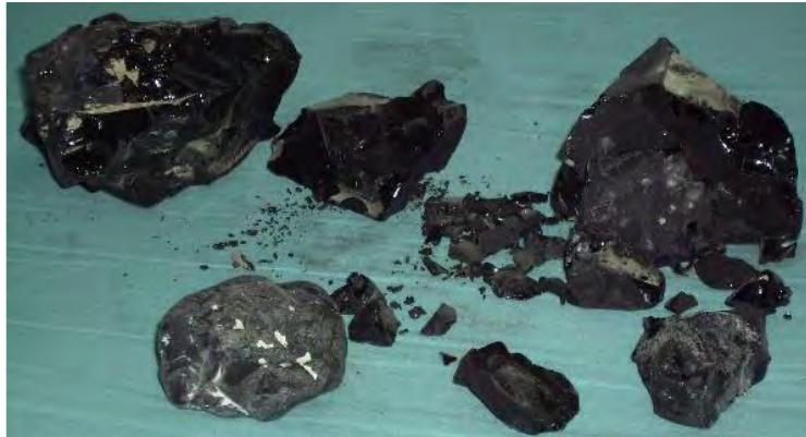
Figura 23: Estado del asfalto sólido temperatura < 25°C Fuente: Incoasfaltos, 2016
