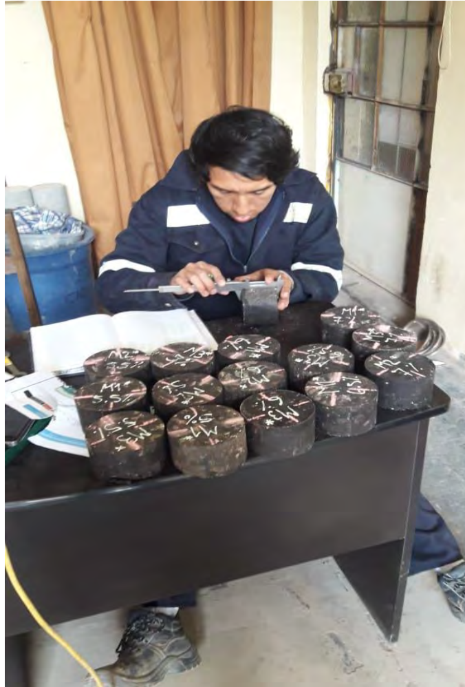
Figura 58: Medición de altura y diámetro Fuente: Laboratorio Centauro Ingenieros
