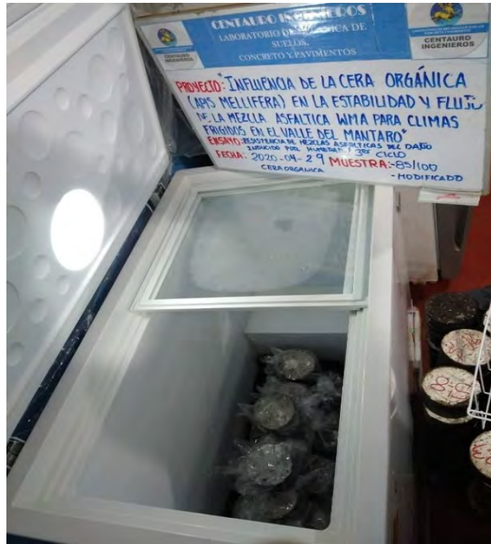
Figura 73: Briquetas en ciclo de congelamiento Fuente: Laboratorio Centauro Ingenieros
