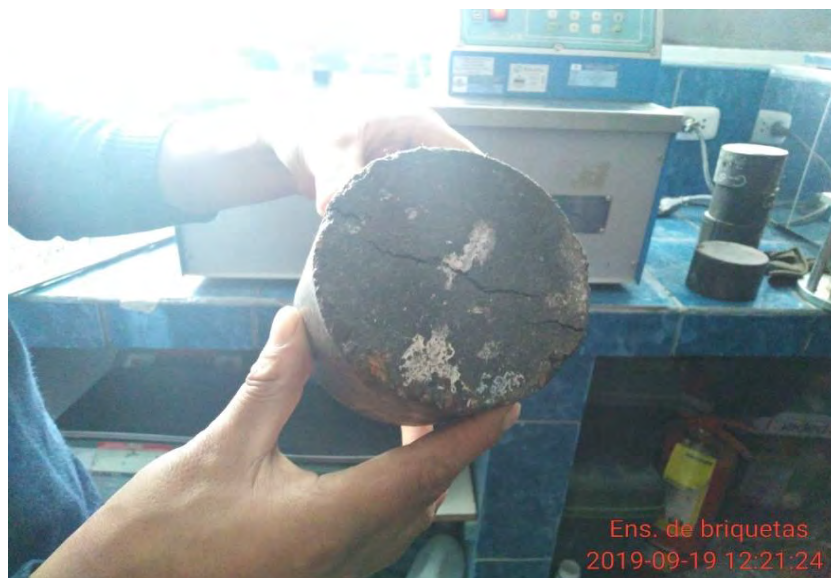
Figura 111: Falla test de Lottman Fuente: Laboratorio Centauro Ingenieros
