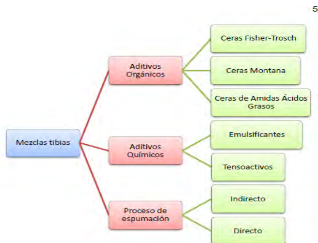
Figura 31: Resumen de los métodos para producir mezclas tibias Fuente: Labic, (2012)
