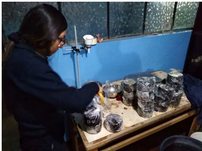
Figura 107: Preparado mezcla asfáltica ciclo de congelamiento Fuente: Laboratorio Centauro Ingenieros
