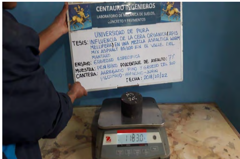
Figura 95: Ensayo gravedad específica Bulk Fuente: Laboratorio Centauro Ingenieros
