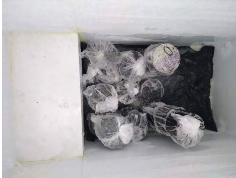
Figura 114:Ciclo de congelamiento briquetas Fuente: Laboratorio Centauro Ingenieros
