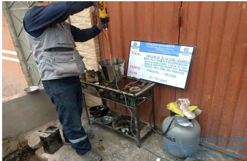
Figura 98: Modificación del asfalto con cera orgánica Fuente: Laboratorio Centauro Ingenieros
