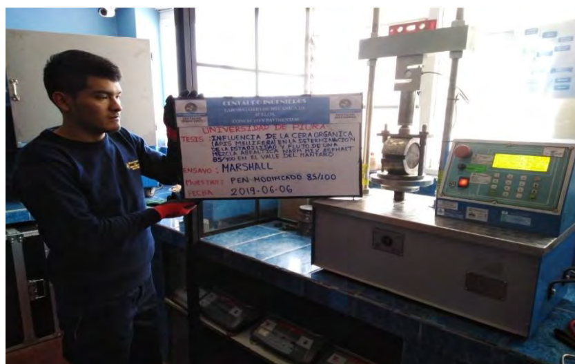
Figura 96: Ensayo Rotura Marshall Fuente: Laboratorio Centauro Ingenieros
