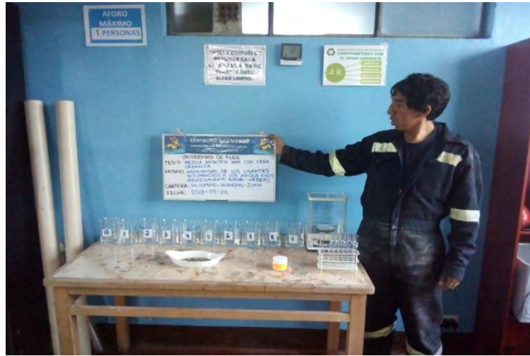
Figura 81: Ensayo Riedel Weber Fuente: Laboratorio Centauro Ingenieros
