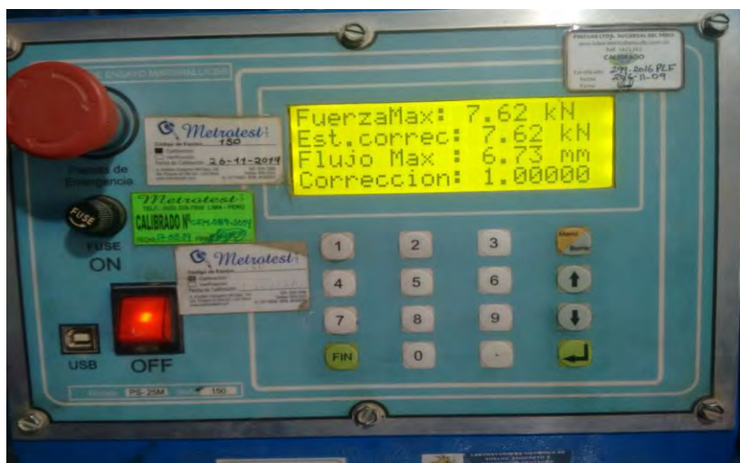
Figura 97: Resultado Ensayo Marshall Fuente: Laboratorio Centauro Ingenieros
