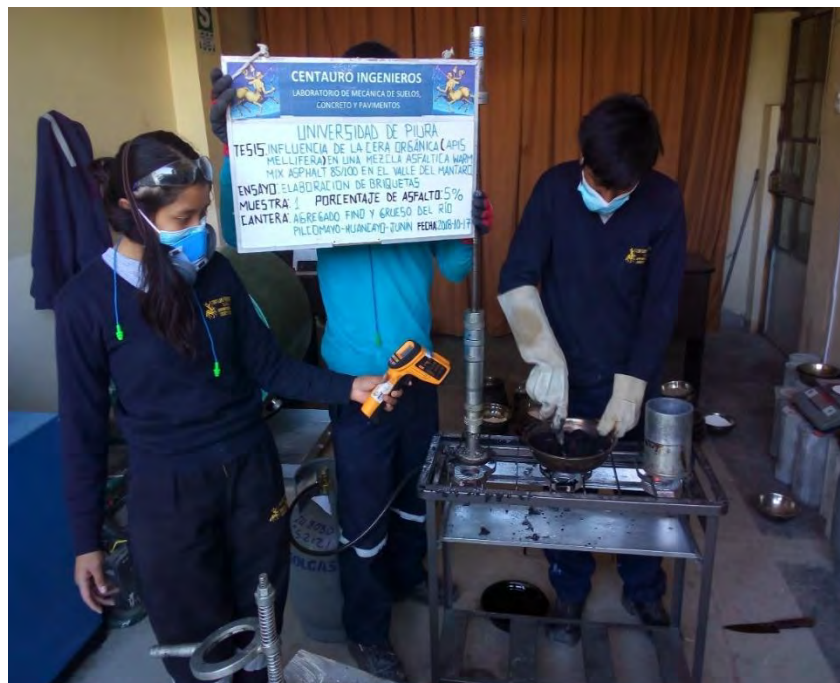
Figura 90: Fabricación de mezcla Asfáltica Fuente: Laboratorio Centauro Ingenieros
