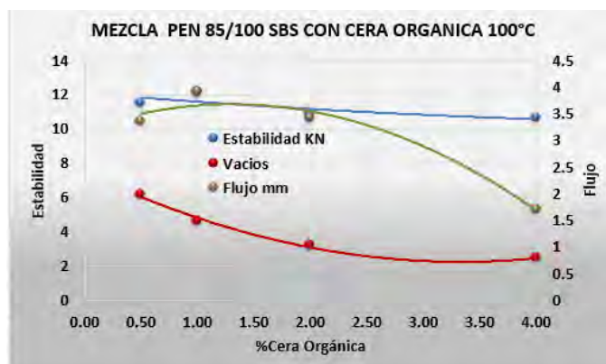
Figura 135: Relación flujo, estabilidad y vacíos Mezcla Asfáltica PEN 85/100 SBS con cera orgánica a 100°C
