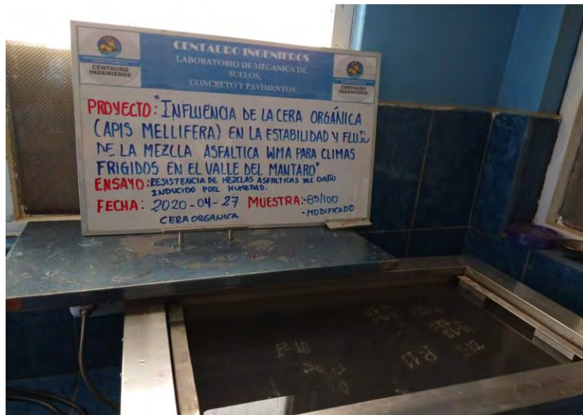
Figura 112: Procedimiento de ensayo test Lottman Fuente: Laboratorio Centauro Ingenieros
