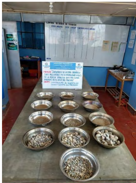
Figura 55: Ensayo Durabilidad al sulfato de sodio Fuente: Laboratorio Centauro Ingenieros
