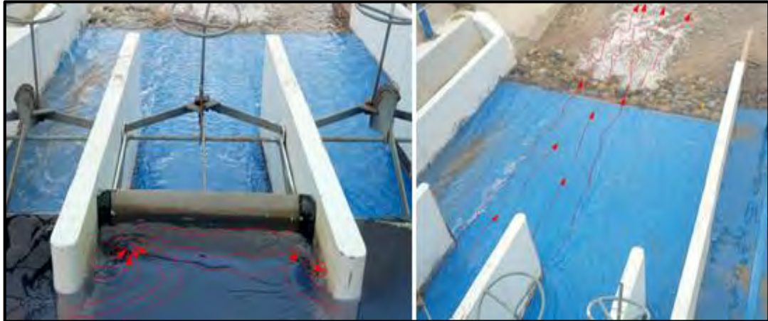
Figura 5.35. Comportamiento del flujo para Q = 66 \text{ m}^3/\text{s} . – Compuerta 2.
