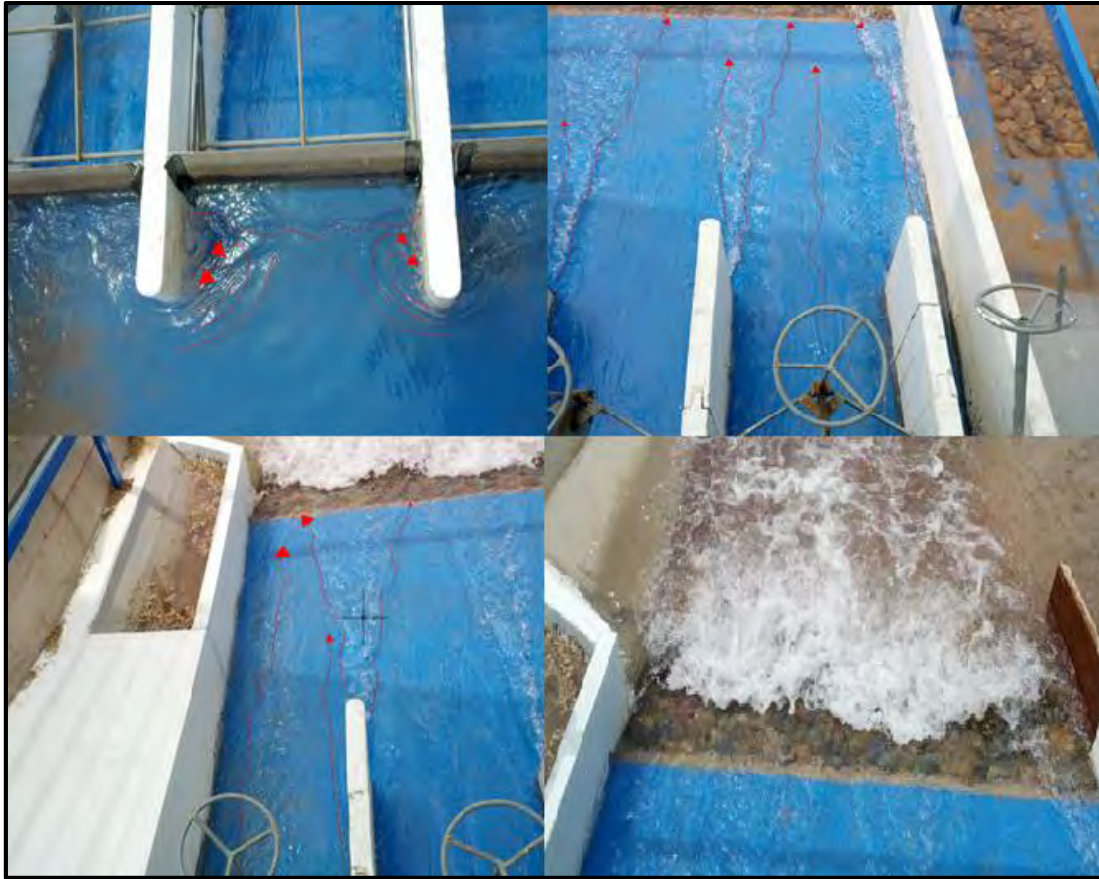
Figura 5.53. Comportamiento del flujo para Q = 308.5 \text{ m}^3/\text{s} . – Compuerta 1, 2 y 3.
