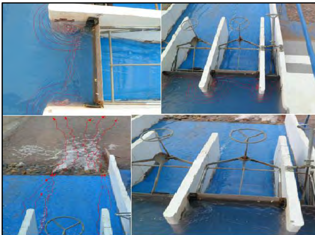
Figura 5.26. Comportamiento del flujo para Q = 66.5 \text{ m}^3/\text{s} . – Compuerta 1.
