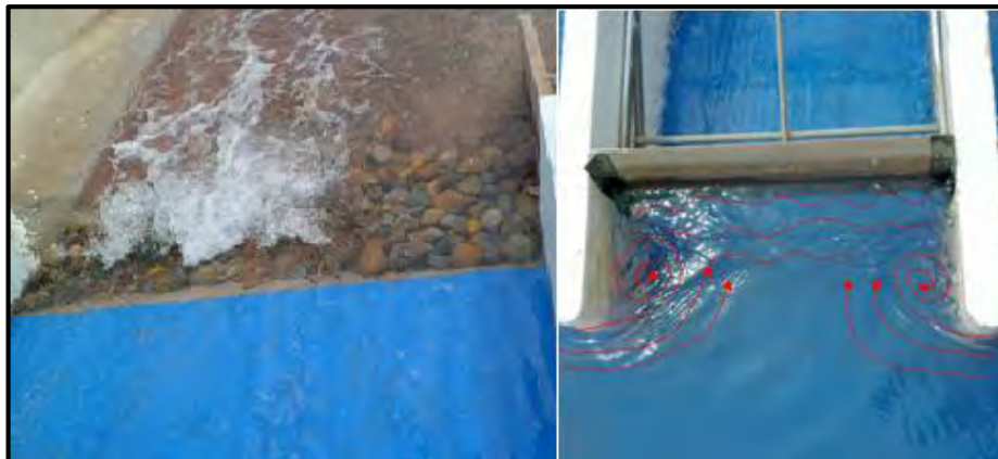
Figura 5.39. Comportamiento del flujo para Q = 148.95 \text{ m}^3/\text{s} . – Compuerta 2.
