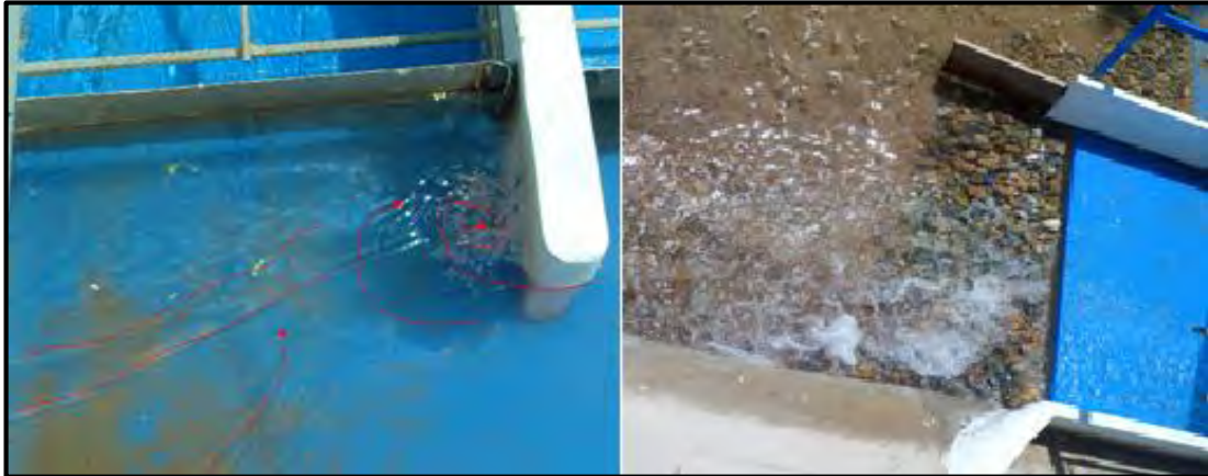
Figura 5.43. Comportamiento del flujo para Q = 66.44 \text{ m}^3/\text{s} . – Compuerta 3.
