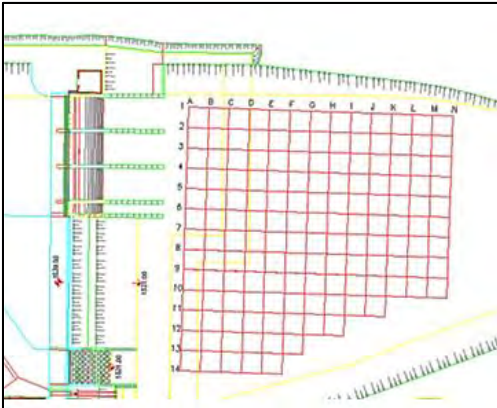
Figura 4.22. Localización de puntos para la toma de datos en el lecho móvil.
