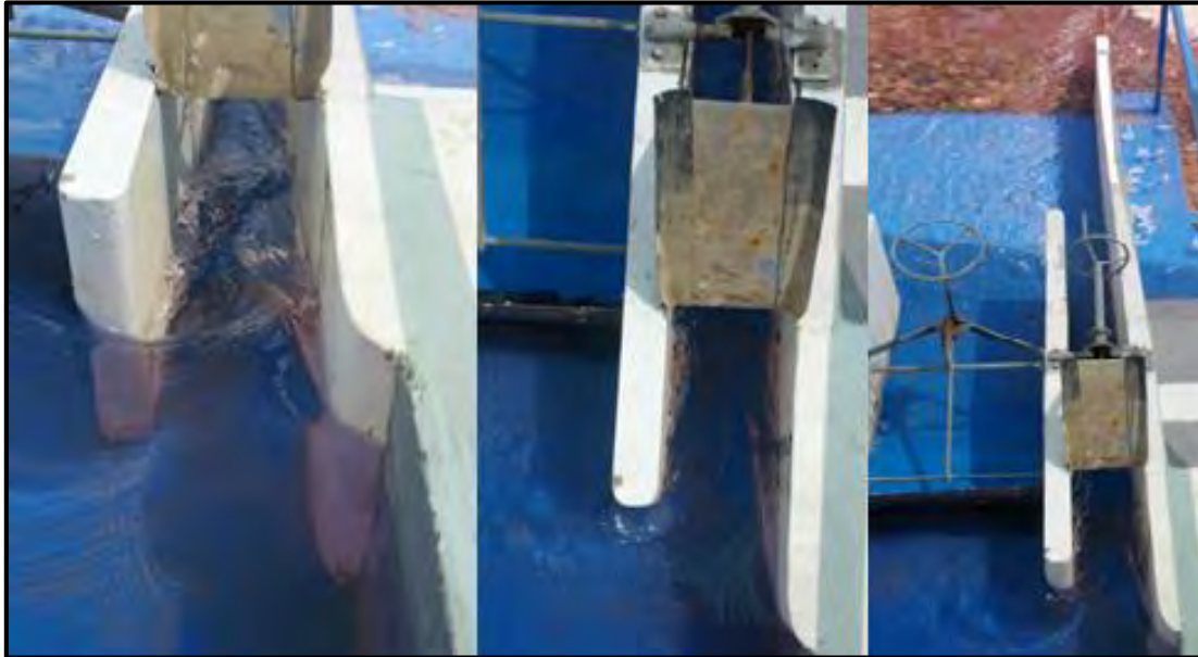
Figura 5.58. Comportamiento del flujo para Q = 55 m 3 /s. – Canal de Limpia.
