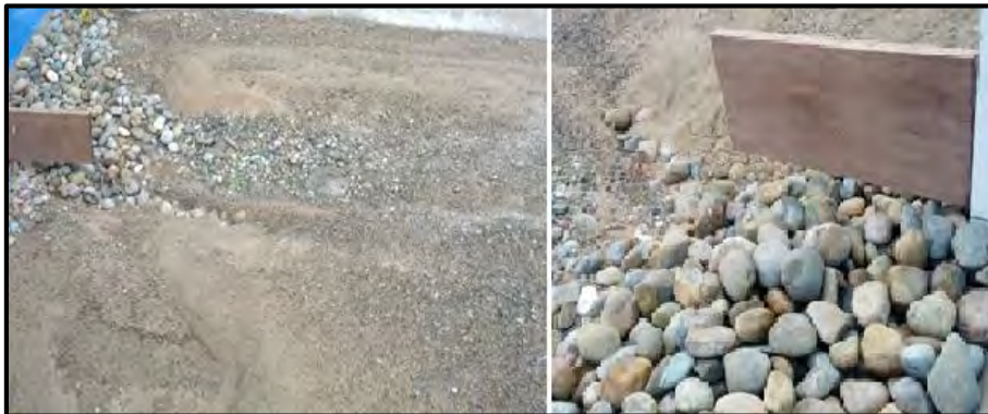
Figura 5.30. Resultados de la erosión para Q = 117 \text{ m}^3/\text{s} . – Compuerta 1.
