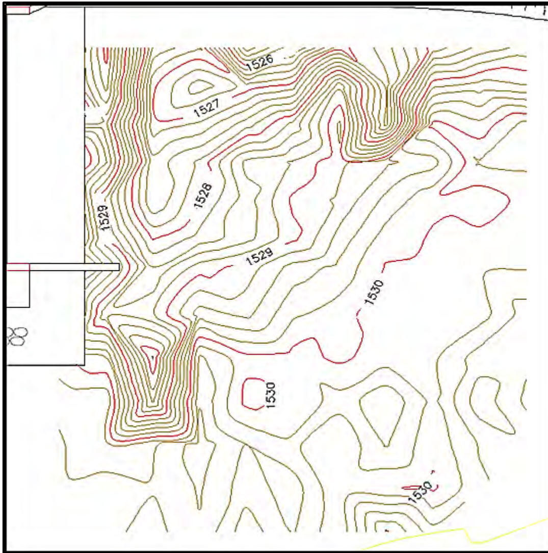
Figura 5.46. Curvas de nivel para erosión en ensayo Q = 102.18 \text{ m}^3/\text{s} . – Compuerta 3. Fuente: Informe parcial N°3 – Modelo hidráulico de las obras de represamiento y captación del proyecto especial de irrigación e hidroenergético del Alto Piura.
