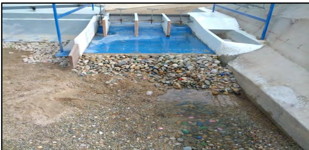
Figura 5.55. Resultado de erosión para Q = 308.5 \text{ m}^3/\text{s} . – Compuerta 1, 2 y 3. Fuente: Informe parcial N°3 – Modelo hidráulico de las obras de represamiento y captación del proyecto especial de irrigación e hidroenergético del Alto Piura.
