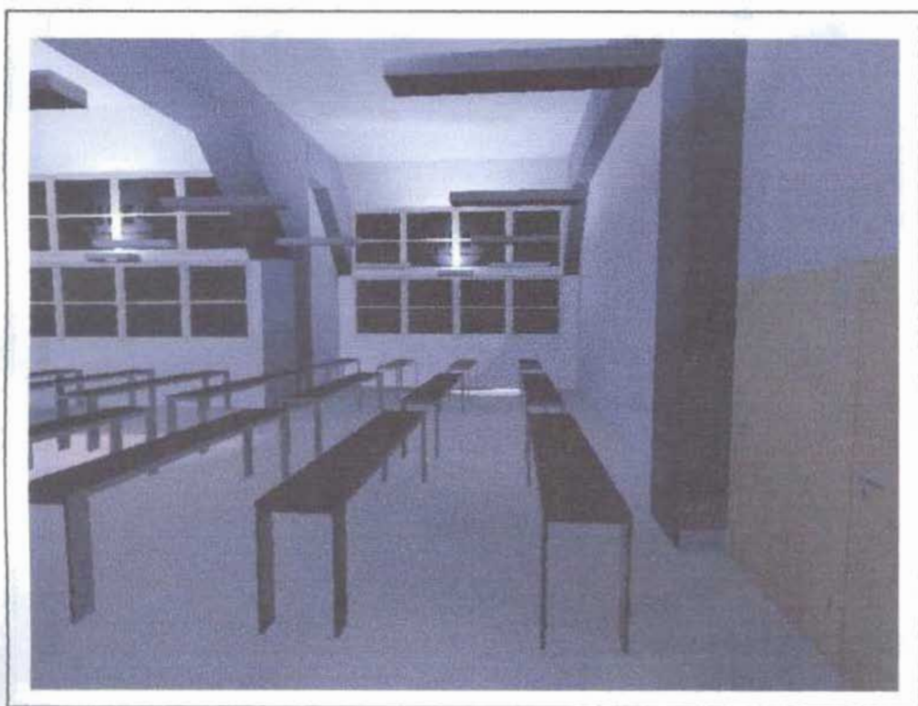
Figura 5.9. Sala de Lectura, iluminación por reflejo del techo.
