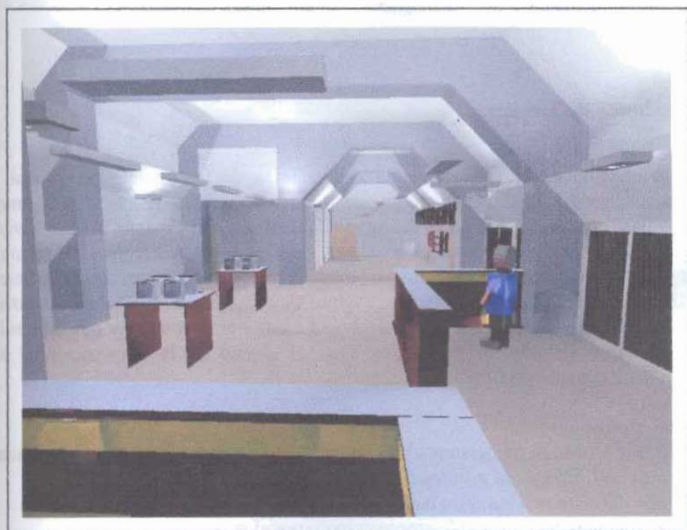
Figura 5.3. Hall de ingreso a la biblioteca, iluminación por reflejo del techo.
