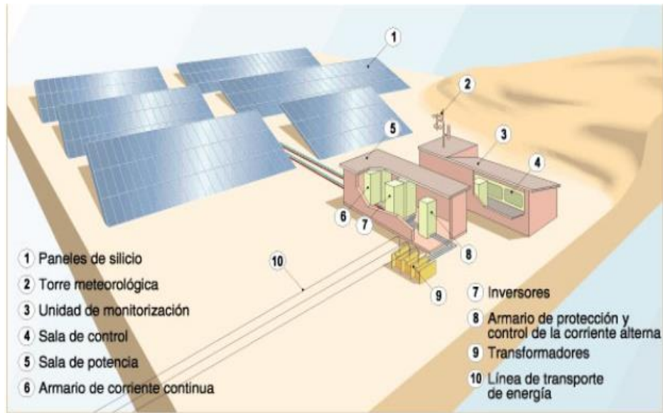
Figura 27. Funcionamiento de una central fotovoltaica
