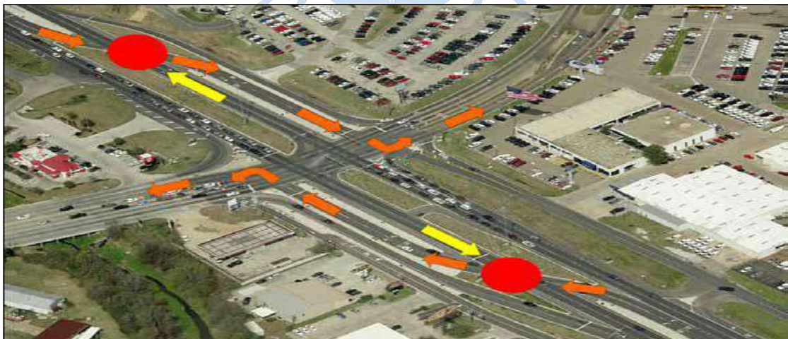
Figura 22. Giro a la izquierda el movimiento de cruce en una intersección DLT parcial en Baton Rouge, LA. Fuente: Federal Highway Administration
