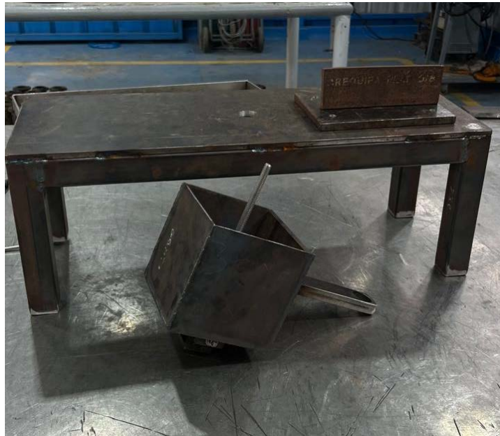
Figura 62 Mesa de soporte de motorreductor
