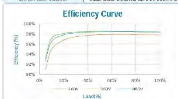
Figura 29. Características del Inversor Huawei SUN2000L-5TKL
