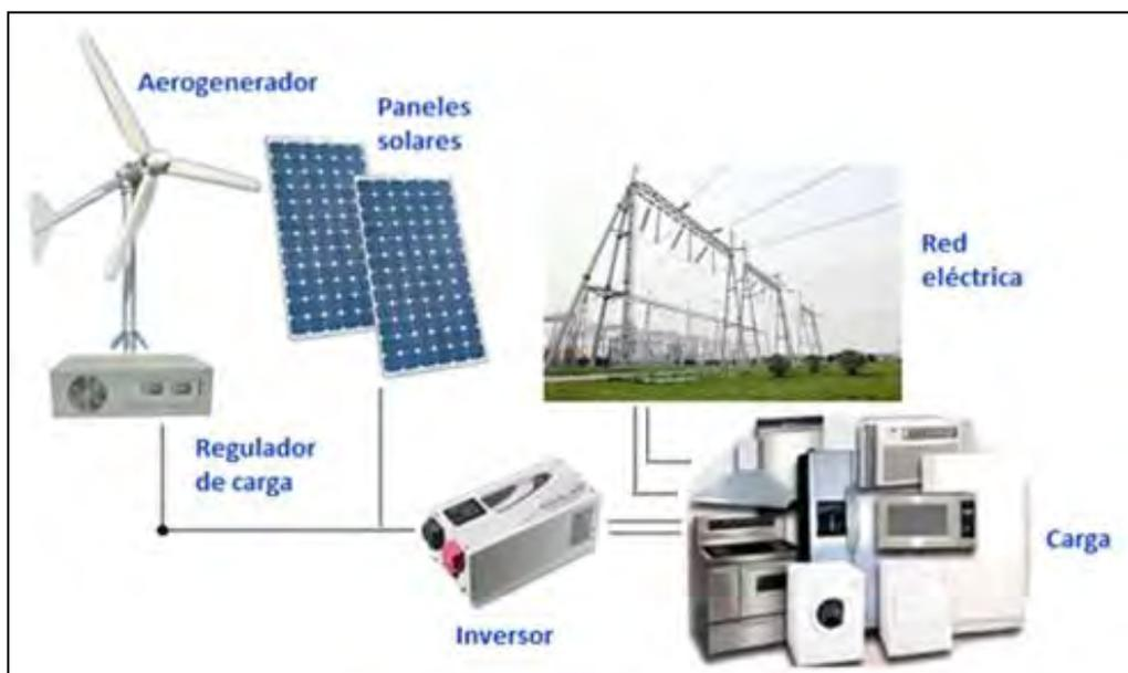
**Figura 1.2.-** Esquema de instalación de un sistema híbrido conectado a la red eléctrica.<sup>6</sup>
