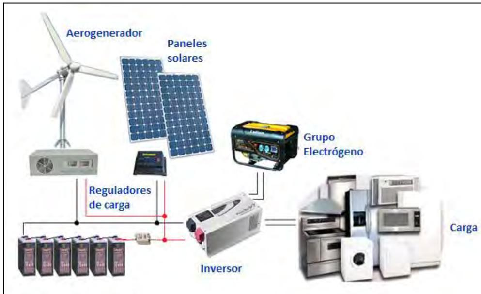
**Figura 1.1.-** Esquema de instalación de un sistema híbrido con autonomía.<sup>5</sup>
