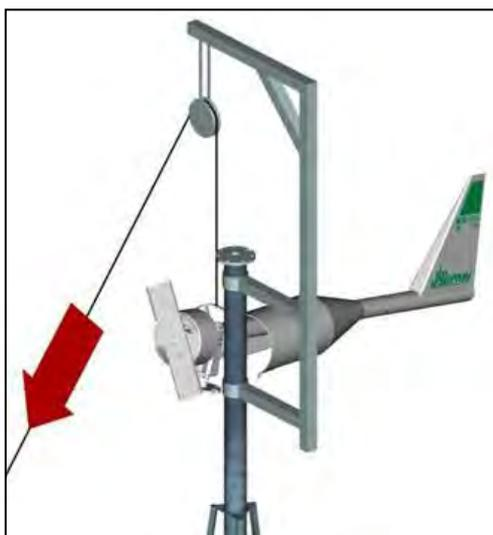
**Figura G.3.-** Esquema para el izaje y montaje del aerogenerador<sup>230</sup>
