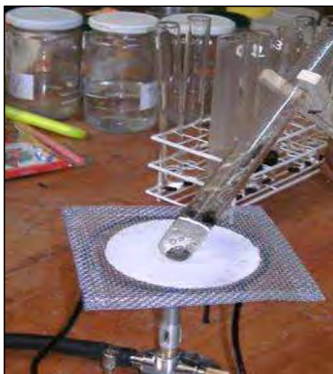
Figura 26. Ensayo Riedel-Weber para la mezcla GCR- asfalto
