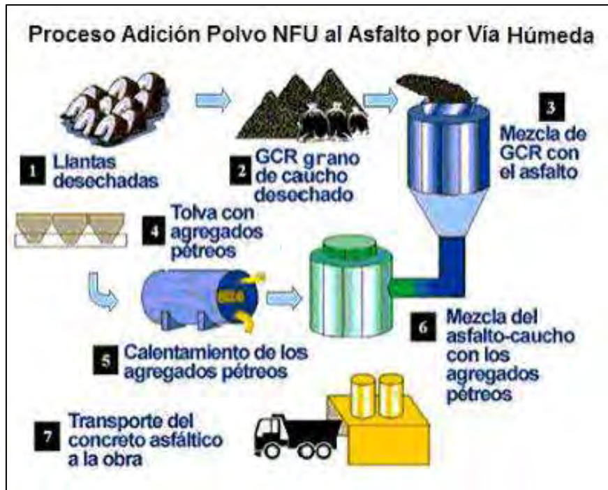
Figura 12. Fabricación de asfalto modificado con caucho por vía húmeda
