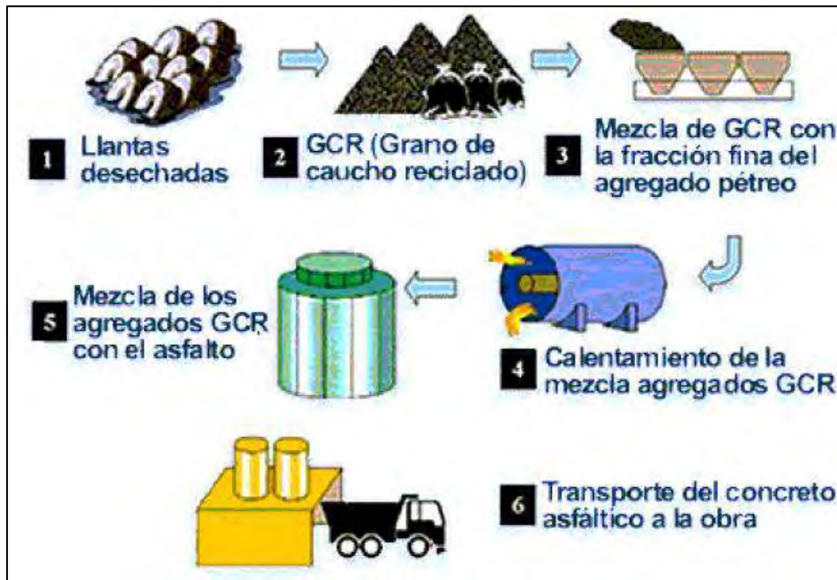
Figura 13. Fabricación de asfalto modificado con caucho por vía seca
