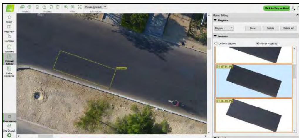
Figura 49. Limpieza del vehículo en la ortofoto.
