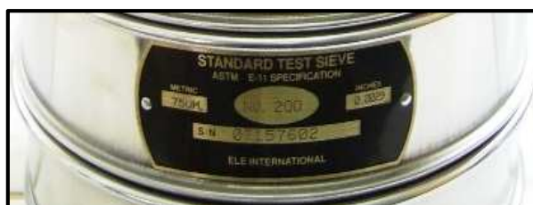
Fig. 3.4 Tamiz con designación ASTM N° 200
