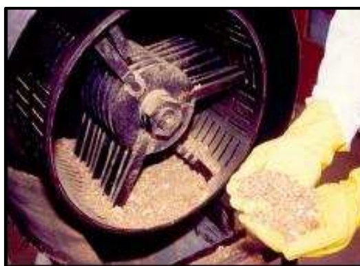
Fig. 3.1 Molino trillador de martillos 27
